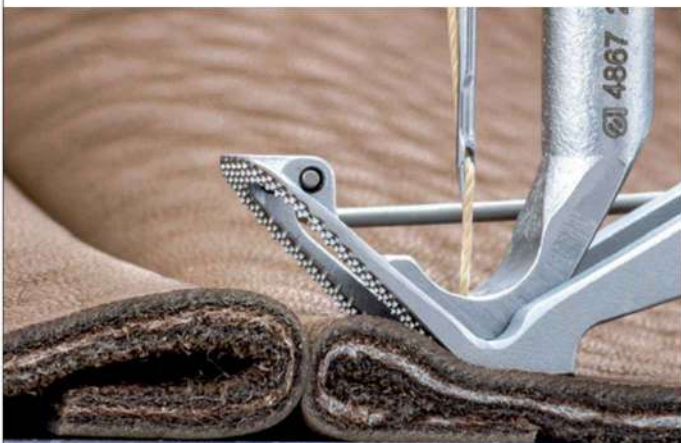
Nähergebnis ohne „MTD“ Sewing result without “MTD”
