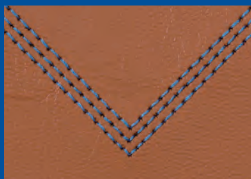
Velocità di cucitura: 2800punti/min, lunghezza punto:4mm
